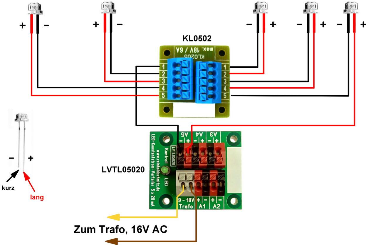
Anschluß von 5 Stück LED's am Ausgang A5 vom LVTL05020 mit Lötverbindung.
