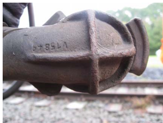
Abbildung 34: Gekennzeichneter Luftkopf einer Hauptluftbehälterleitung
