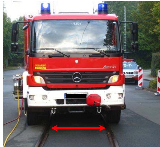
Abbildung 51: Fehlerhafte Fahrzeugabstellung im Gefahrenbereich der Gleise
