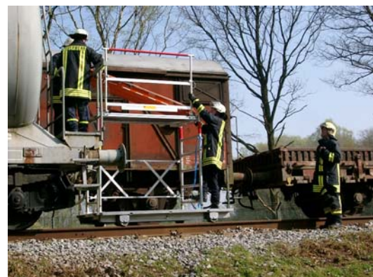
Abbildung 48: Rollpalette und Arbeitsplattform zusammen einsetzen
