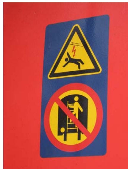
Abbildung 2: Warnung Oberleitung an Fahrzeugen
