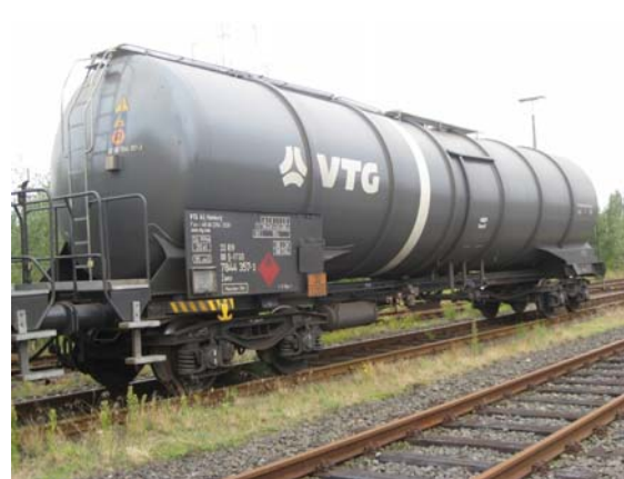
Abbildung 24: Mineralölkesselwagen mit Zwangsbelüftungssystem
