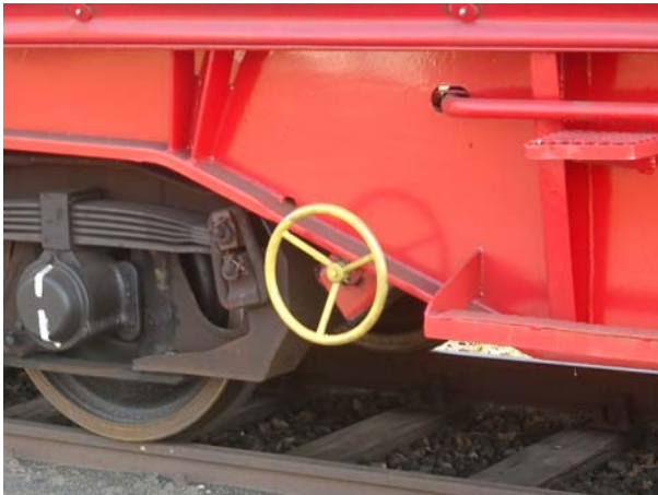
Abbildung 38: Güterwagen verfügen teilweise über bodenbedienbare Feststellbremsen
