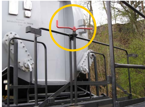
Abbildung 39: Feststellbremseinrichtungen auf der Pufferbrücke
