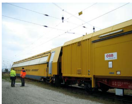
Abb. 9-8: Mobile Instandhaltungseinheit mit geschütztem Arbeitsraum (rechts) und integrierem Sozialraum (Hersteller: ROBEL Bahnbaumaschinen GmbH).
