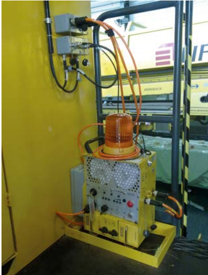
Abb. 8-6: Funkempfänger, der vom Sicherungsunternehmen zur Ansteuerung der Maschinenwarnanlage auf die Gleisbaumaschine gestellt wird.
