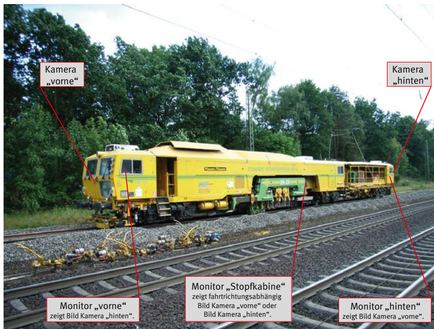
Abb. 9-4 : Ausrüstung einer Stopfmaschine mit Kamera-Monitor-Systemen
