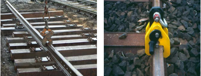
Abb. 7-11: Schienenhebezange ohne Öffnungssperre (links, nicht zulässig) und mit Öffnungssperre (rechts).
