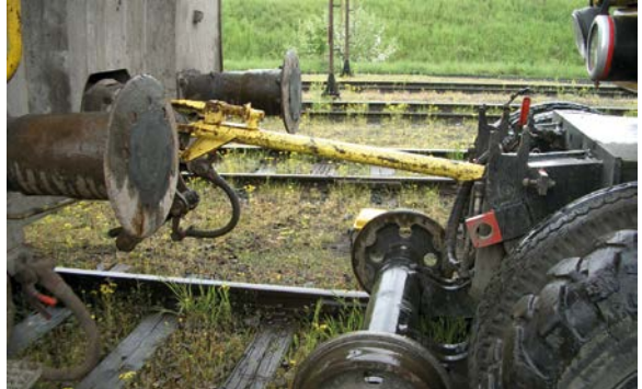
Abb. 7-16: Vom Bahnbetreiber zugelassene Kuppelstange.
