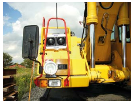
Abb. 7-21: Mobile funkangesteuerte Signalgeber auf Zweiwegebaggern (Testeinsatz für akustische Messungen).
