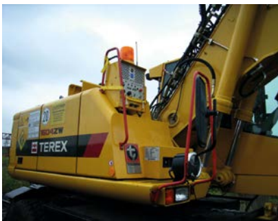
Abb. 7-21: Mobile funkangesteuerte Signalgeber auf Zweiwegebaggern (Testeinsatz für akustische Messungen).
