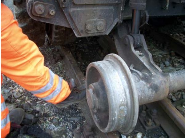
Abb. 7-8: Quetschgefahr zwischen Unterwagen und Schienenachse.
