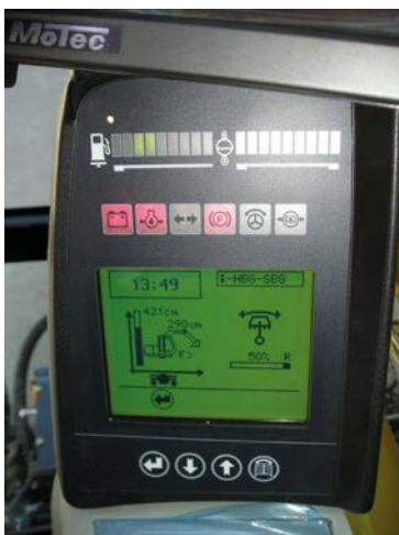
Abb. 7-22: Display für Hub- und Schwenkbegrenzung am Zweiwegebagger.
