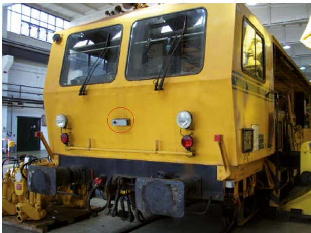
Abb. 9-4 : Ausrüstung einer Stopfmaschine mit Kamera-Monitor-Systemen
