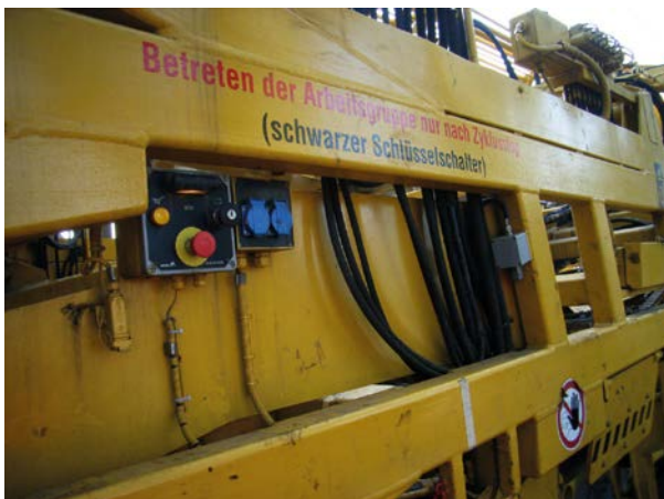
Abb. 8-12: Das Betreten der Gefahrenbereiche der Arbeitseinrichtungen ist nur zulässig, wenn diese gegen ungewollten Wiederanlauf gesichert sind (Beispiel: Umbauzug).
