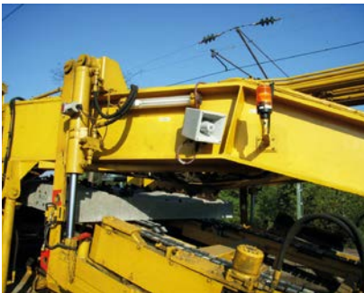
Abb. 2-14: Funkangesteuerte Warnsysteme auf Gleisbaumaschinen (links: Hersteller Schweizer Electronic AG, rechts: Hersteller Zöllner Signal GmbH).
