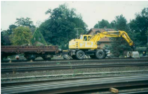
Abb. 7-14: Bewegen von Waggonen mit dem Zweiwegebagger.
